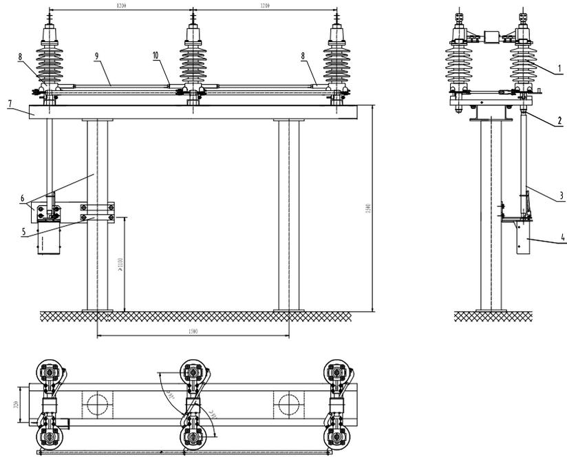
**GW4-40.5 disconnector 3P linkage installation diagram**
